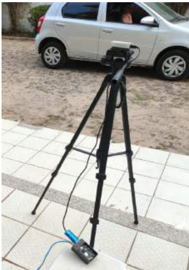
Figura 34: Teste de campo com entrada de filmagem ao vivo com Raspberry
