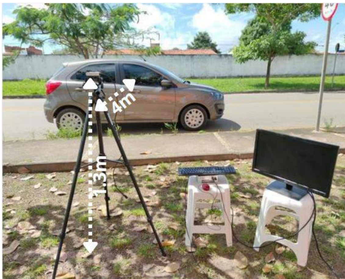
Figura 30: Distâncias da câmera para testes com entrada de dados ao vivo pela Realsense
