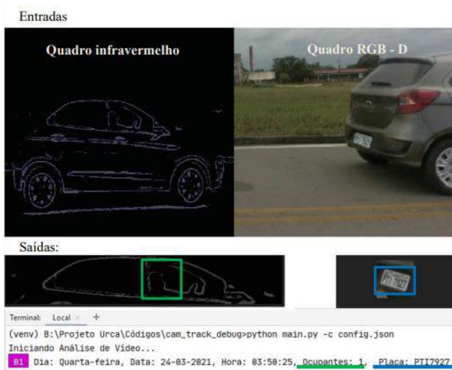
Figura 12: Resultados do algoritmo de capturas para os pontos C (câmera de profundidade) e D (câmera RGB)
