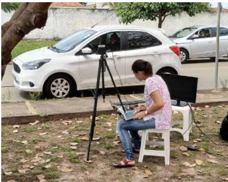
Figura 35: Teste de campo com entrada de filmagem ao vivo com Mini PC
