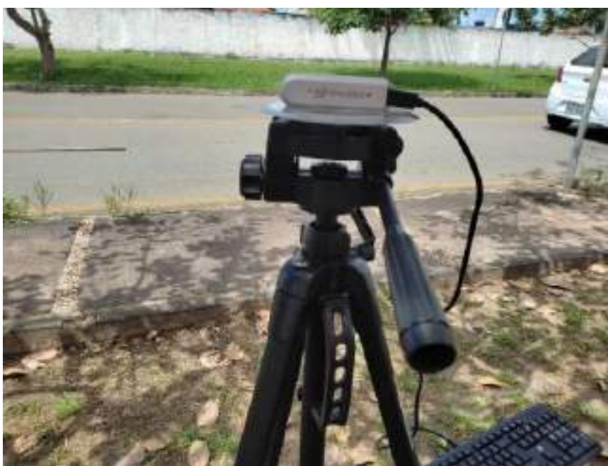
Figura 32: Posição da câmera a 83° para captura de placas
