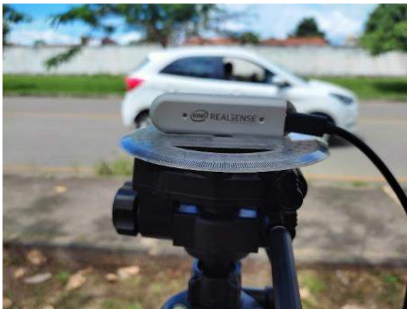
Figura 31: Posição da câmera com angulação a 90°
