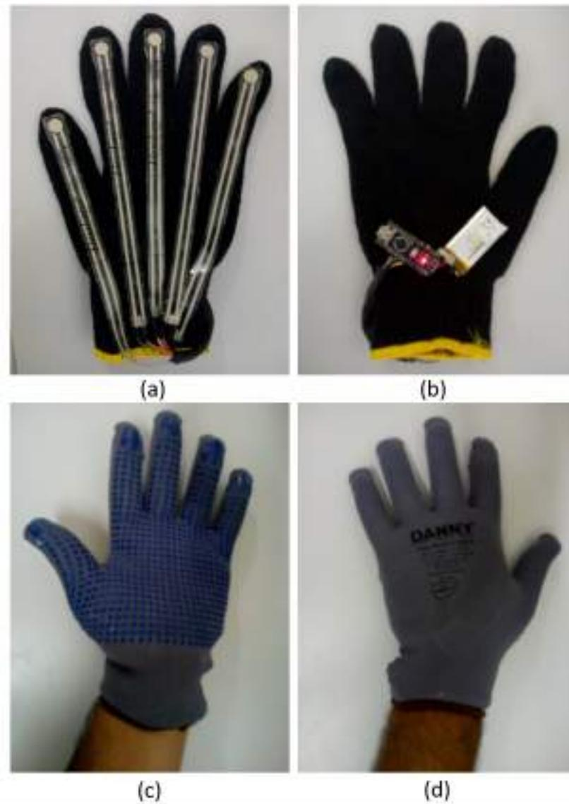
Figura 3.5: Protótipo da luva: a) luva com sensores colados; b) Arduino Nano com a bateria, visão posterior; c) segunda camada de luva para proteger os sensores; d) vista posterior da segunda camada
