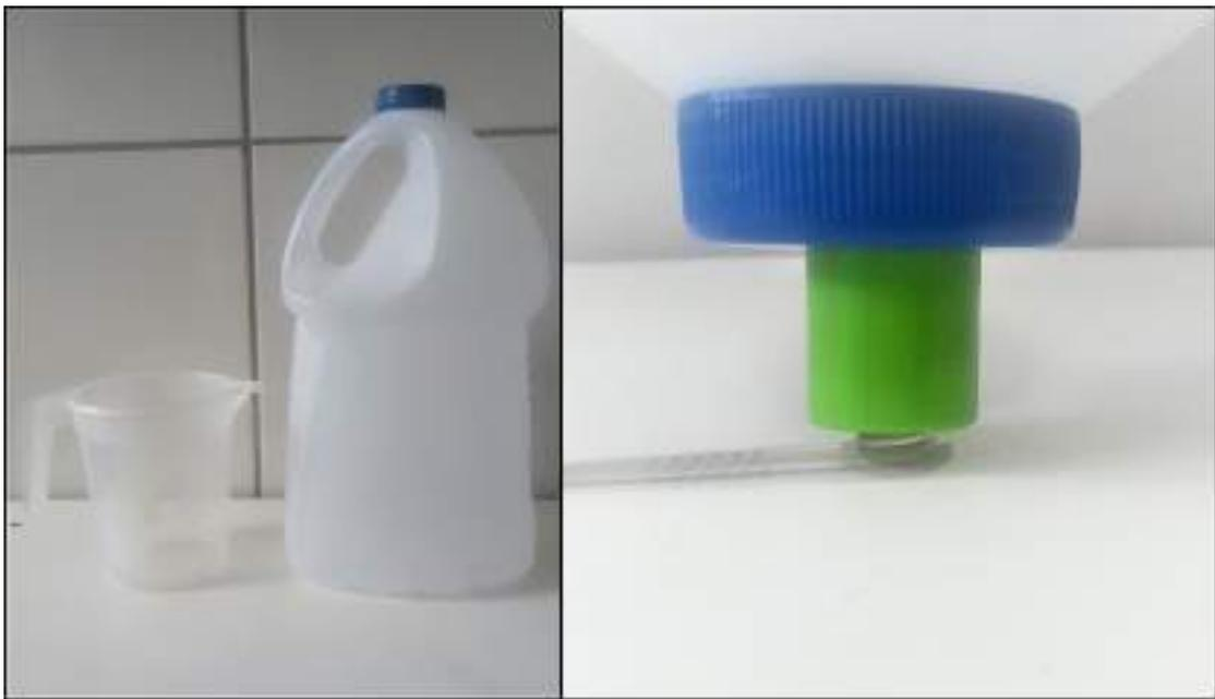
Figura 3.8: Lista de materiais para o condicionamento e calibração. A direita, o concentrador entre a carga de teste e o sensor
