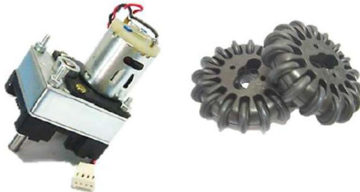
Figura 30. Moto redutor e rodas do robô Scisoccer
