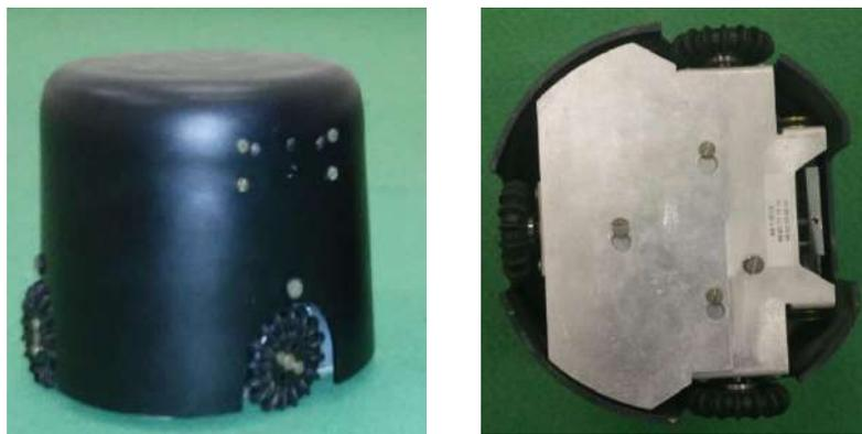
Figura 23. Robô móvel Scisoccer Xbot
