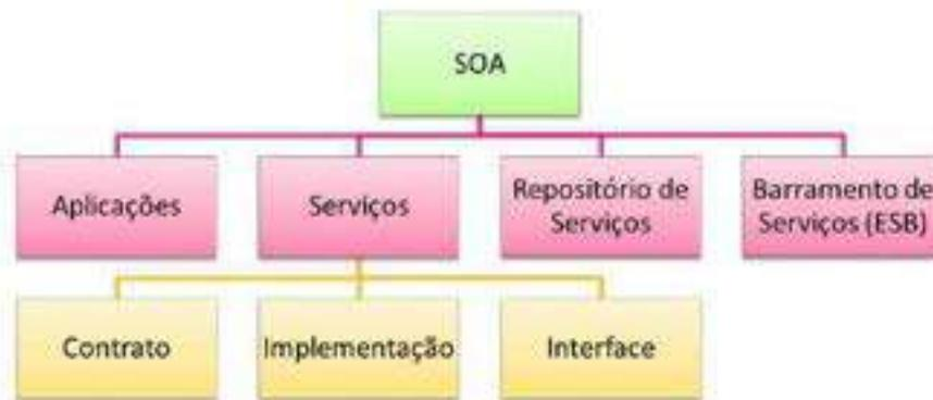
Figura 6. Elementos da Arquitetura Orientada a Serviços. (KRAFZIG, BAKE e SLAMA, 2004).
